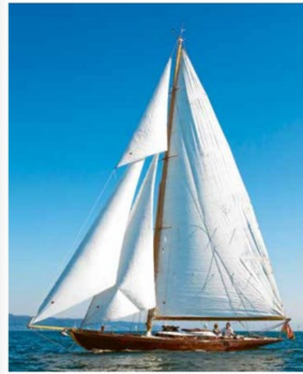
Die Hera hat eine Kuttertaklung und führt Fock, Klüver und Flieger. Das ursprüngliche Gafftrigg musste schon 1920 weichen.
