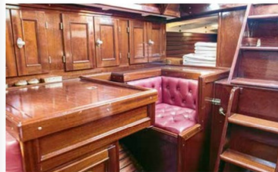
Der Navigationsplatz mit Kartentisch. Der Innenausbau ist in traditioneller Technik mit geschlitzten Rahmen und Füllungen angefertigt. Die Außenhaut ist durch eine Wegerung verkleidet.
