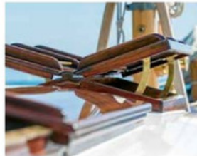
Der moderne Lukendeckel aus Aluminium und Plexiglas einer früheren Restauration wurde durch ein klassisches Skylight ersetzt.
