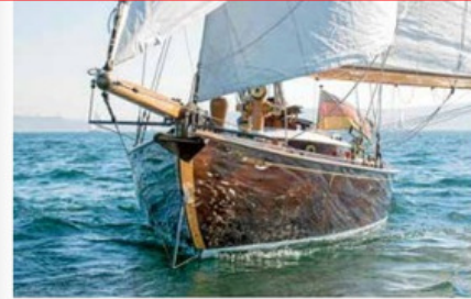
Aufwändige Verstagung: Klüverbaum mit ausgespreizten Klüverstagen, Stampfstock und Wasserstag.
